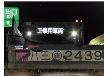
「首都圏中央連絡自動車道 所沢管理事務所管内舗装補修工事」での実装試験も行っており、実装試験にご協力いただいたダンプ運転手様からは、スイッチ操作のみで簡単に後続車への注意喚起を行うことができるとして高い評価を得ております。当システムの導入によって、従来の工事用車両のハザードランプと黄色回転灯の点灯による注意喚起から大幅に安全性が向上し、高速道路の利用者が安全にストレスなく工事現場を通過してもらうことにも大きく寄与することに期待しております。
