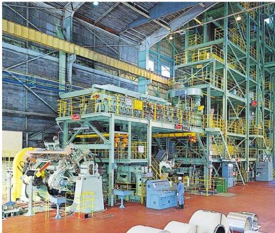
【ステンレス連続光輝焼鈍ライン(BAL)イメージ】
