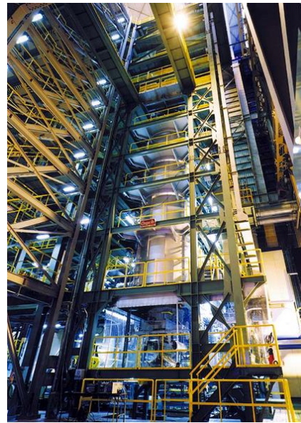
【ステンレス連続光輝焼鈍ライン(BAL)イメージ】
