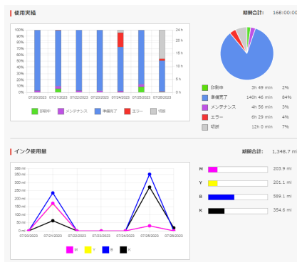
図 7 プリンタ 1 台の稼働履歴画面
