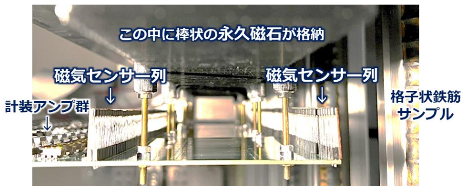
図2 多対センサーモジュール
