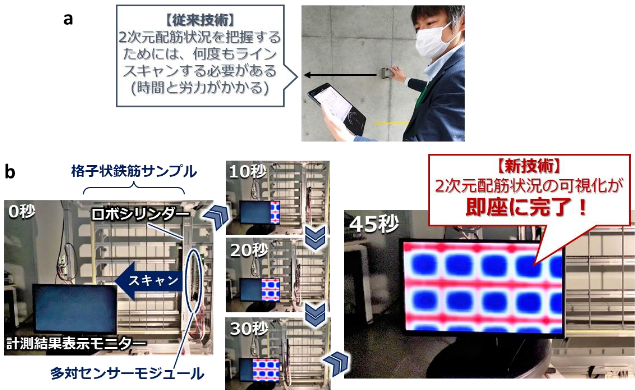
図3 (a)従来の計測手法と、(b)今回開発した2次元スキャナーによる計測の流れ
