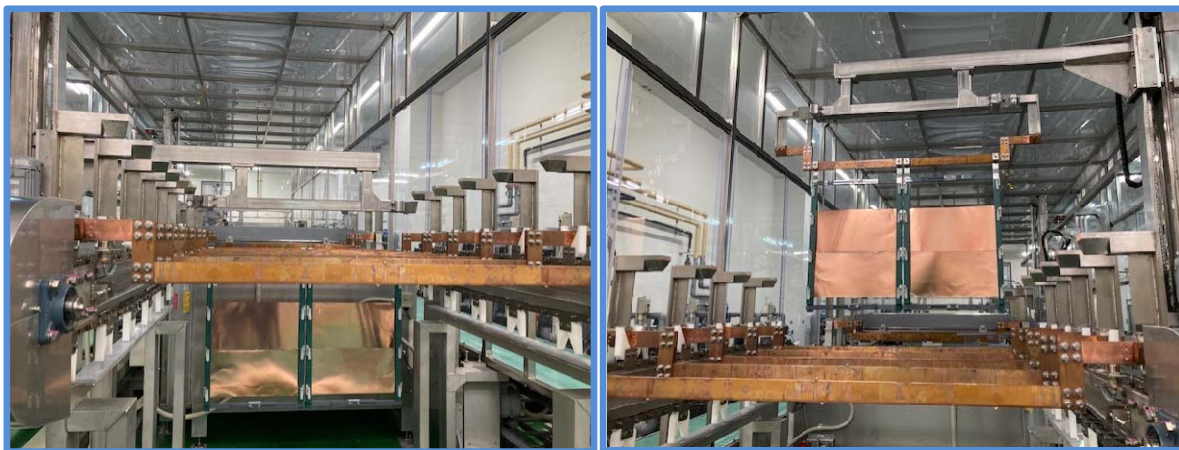
高精度全自動銅めっきライン（基材自動搬送の様子）
