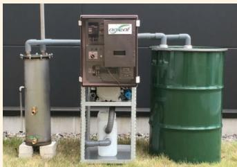
▲農業ハウス栽培用CO<sub>2</sub>貯留・供給装置「agleaf®」
